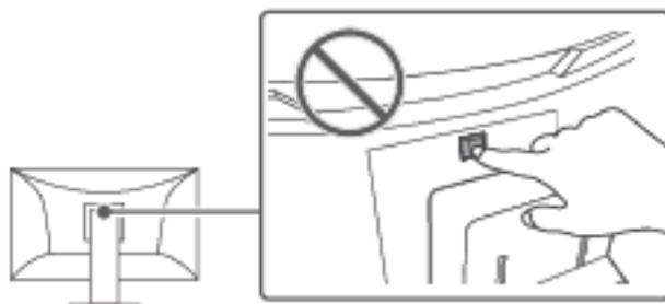
Кнопка блокировки используется только для снятия стойки с монитора. В других случаях использование кнопки блокировки может привести к повреждению изделия или травмированию вследствие отсоединения монитора от стойки.
